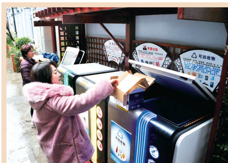
一种自带称重系统并能进行大数据分析的“智能垃圾”分类系统亮相黄浦区外滩街道的保安坊 杨建正 摄
