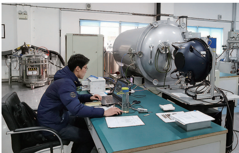
项目组成员李飞飞正在进行整机热真空实验 见习记者 郜阳 摄
