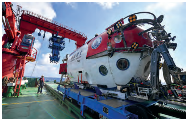
在“探索一号”科考船上拍摄的“深海勇士号”载人潜水器，该潜水器用于水下考古数据采集。
