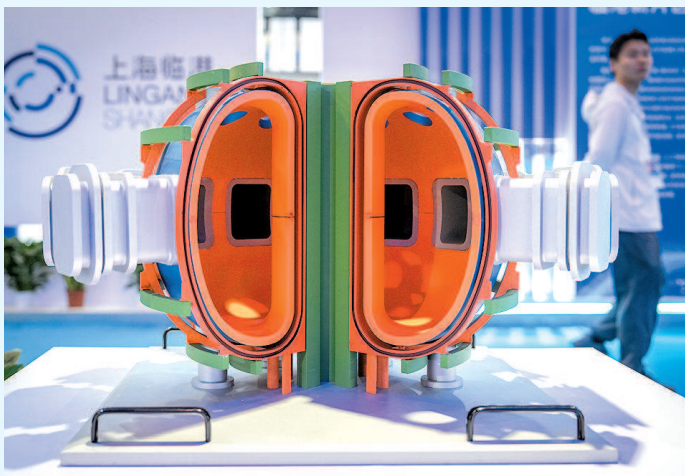
■ 现场展示的洪荒70装置模型是全球首台全高温超导托卡马克实验装置,可产生核聚变,并被誉为“人造太阳” 本报记者 陈梦泽 摄
