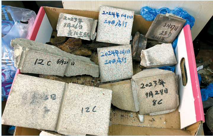
兆丰大厦北楼外墙脱落的瓷砖
