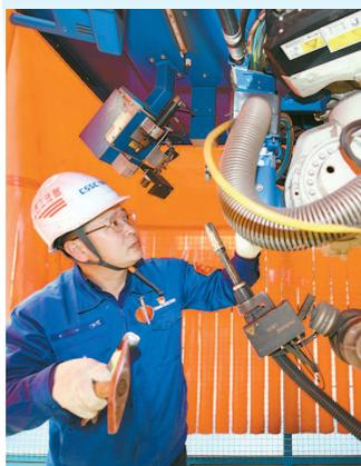
■ 洪刚细致检查激光焊接机械臂 本报记者 徐程 摄
