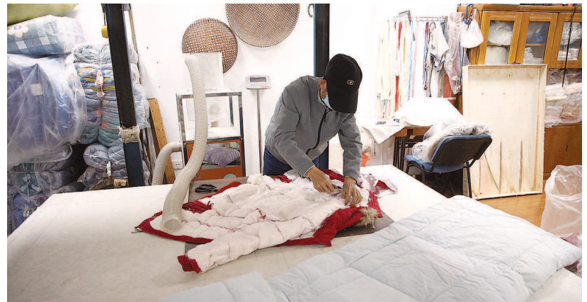
今天上午,童师傅用充绒机把旧衣服里的羽绒吸出来,收集后一并称重,再充入新被子里
