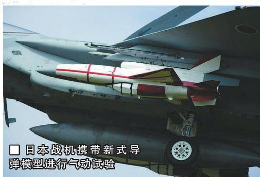
日本战机携带新式导弹模型进行气动试验
