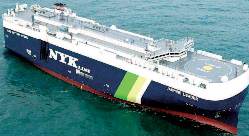
■上海船舶研究设计院为日本船东NYK设计的LNG动力7000车位汽车运输船 采访对象供图
