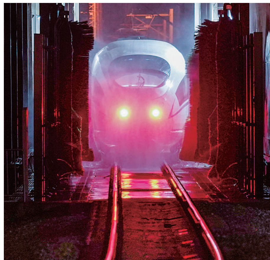
动车返回车库前需要进行外部清洗,清洗液体从高压喷头喷出,洗车库内两侧的毛刷开始自动清洗
