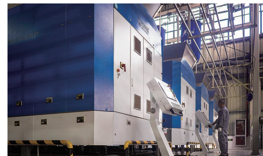
座椅套和布草洗涤的部分由4台全自动隧道式“洗衣龙”完成,根据疫情防控要求,“洗衣龙”内还加入了消毒片和漂白粉
