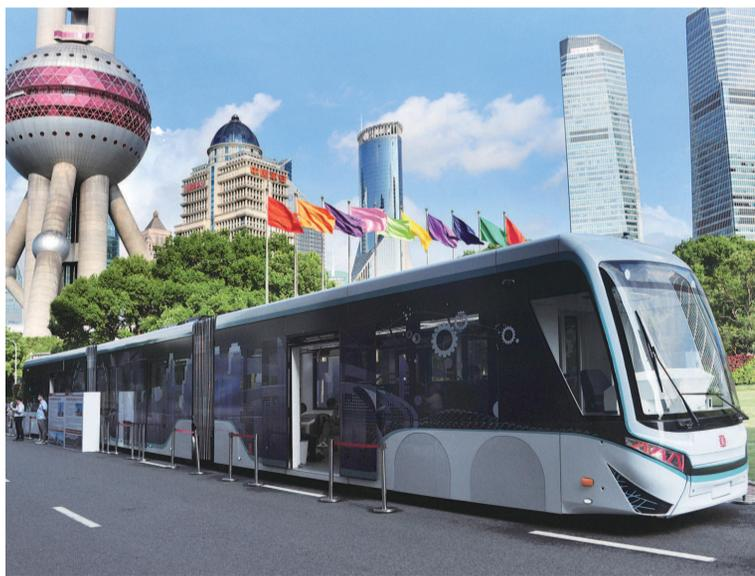
2020中国国际铁路与城市轨道交通大会昨起在上海国际会议中心召开。由中车设计制造的全球首列数字轨道胶轮电车(DRT)成展会一大亮点。作为临港地区中运量公交网用车,国产数轨电车采用以电磁标记为主,视觉导航和卫星导航为辅的数字轨道导向方式,可实时准确定位车辆。地面无需铺设轨道。该款数轨列车总长30.5米,载客量可达302人,最高车速每小时70公里。据悉,上海临港新片区中运量T1示范线滴水湖站今年底初步建成并实现车辆上路试运营。届时,这辆全球新车也将投入实测使用。
