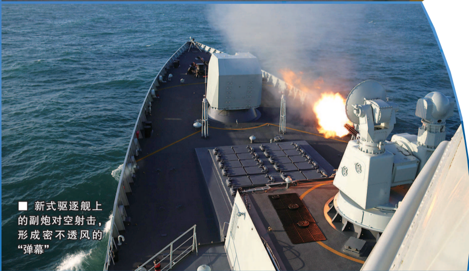
■ 南京舰首部特写,主炮、导弹垂直发射系统、副炮和相控阵雷达天线阵面一览无余
