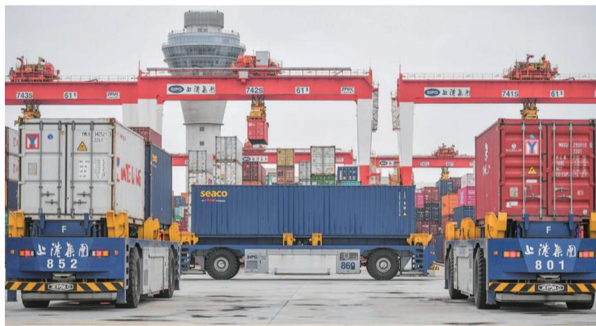
洋山四期自动化码头一派忙碌景象,自动导引车在码头穿梭 本报记者 陈梦泽 摄
