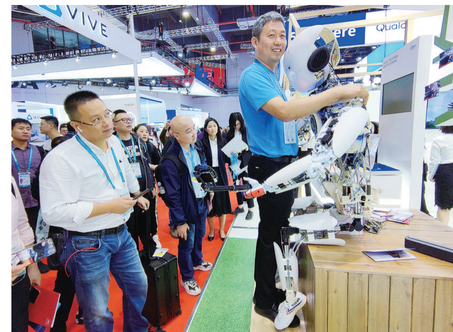
■ 第二届进博会中，名为Roboy的3D打印机器人成了明星。通过周身的传感器与神经网络系统，Roboy拥有了听觉、视觉和感知功能，可以灵活运用躯体感应并回赠参观者的拥抱，甚至还会害羞脸红呢！
