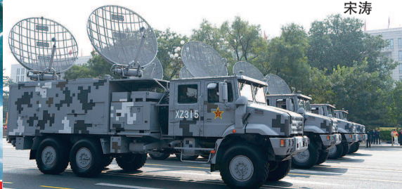
▲ 散射通信车具有通信距离远、通信容量大、可靠性高等特点
