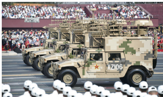
▲ 精确测定辐射源方位的电子战车辆
