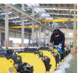
这段时间, 在位于湖州南浔开发 区的浙江蓝光驱动技术有限公司内, 智能数字化生产车间正在赶制外贸订 单。一台台电梯曳引机在这里批量下
